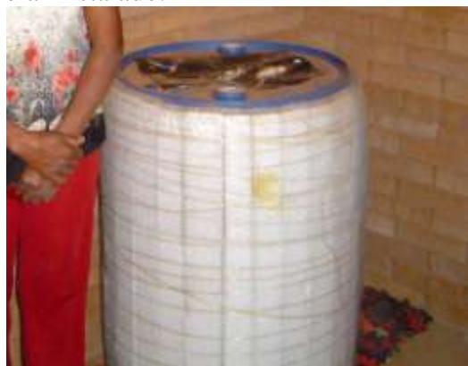
Fig.11: Bombona revestida com isopor e “plástico bolha”–pronta para instalação.
