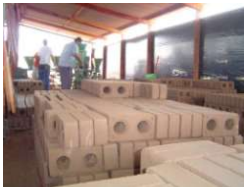
Fig. 4: Barracão e prensa para a fabricação dos tijolos e peças prontas.
